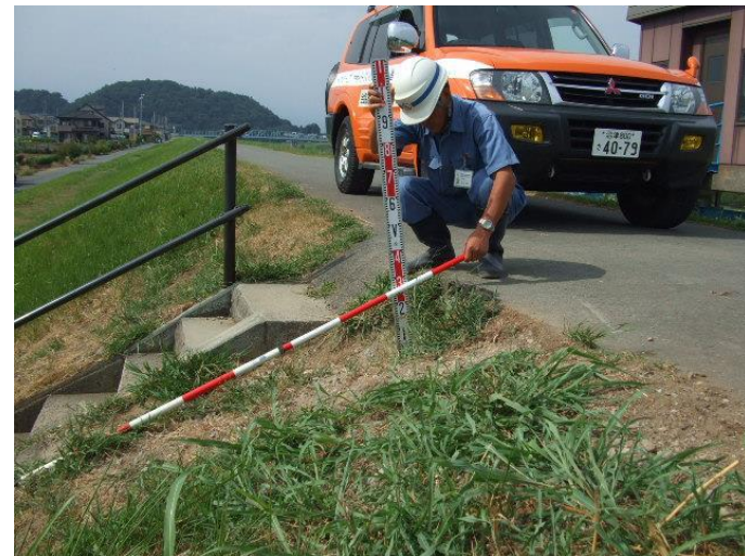
河川管理施設及び許可工作物の維持状況の確認 階段近くの踏み荒らし状況確認
