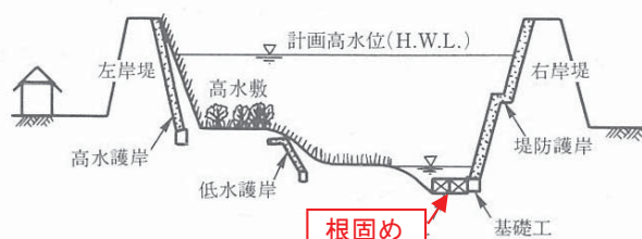
護岸のイメージと根固め
