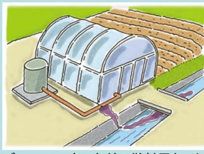
ビニールハウスなどの燃料用タンクの配管の老朽化・亀裂による油漏れ
