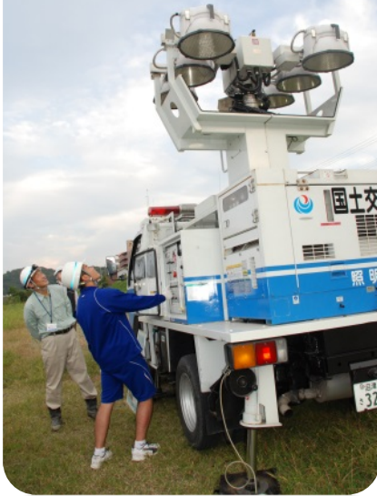
災害対策車両(照明車高さ10m)の操作
