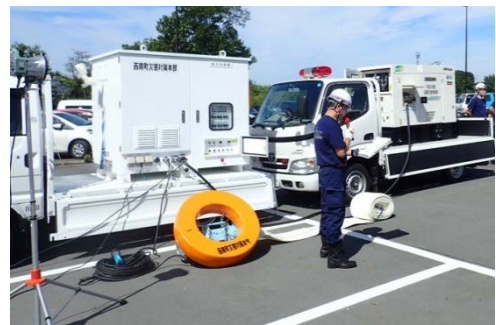
函南町の排水ポンプ車説明
