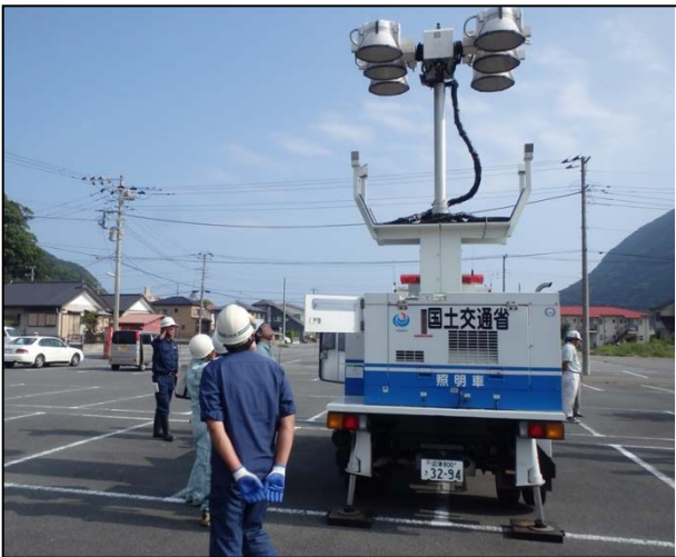
照明車(10m)の設置
