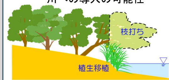
枝打ち・植生移植のイメージ案 (水面に張り出した箇所の枝打ちと産卵基質となる植生(ナガエミクリ等)を移植)
