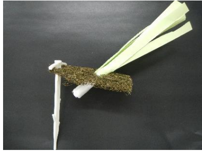
改良型試験マット (供試体固定に生分解性リボンを使用しない)
