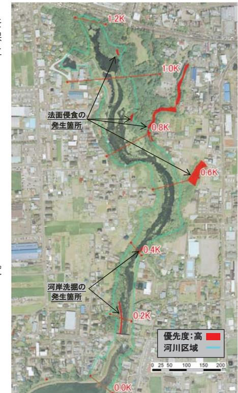
図 5-9 河岸の保全及び水域への土砂流出抑制に係る整備箇所
