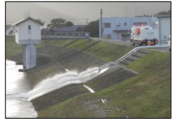
近年の排水ポンプ車稼働実績 かんなみ しんでん (H29: 台風21号(函南町新田地区))
