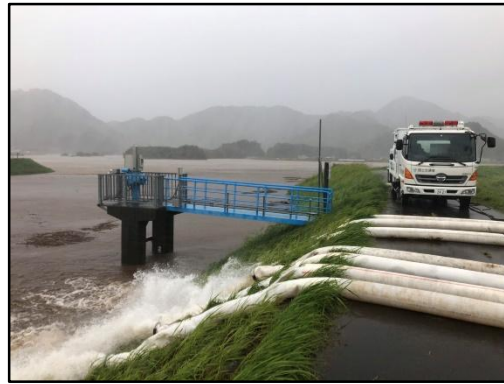
近年の排水ポンプ車稼働実績 みしま みその (R1: 令和元年東日本台風(三島市御園地区))
