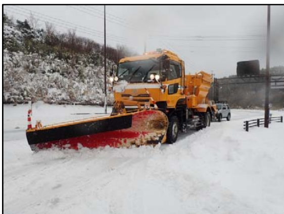
除雪作業(国道1号)
