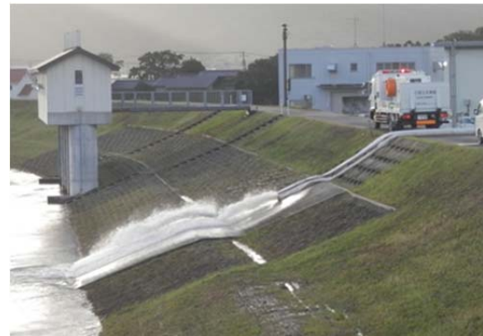
近年の排水ポンプ車稼働実績 (H29: 台風21号(函南町新田地区))
