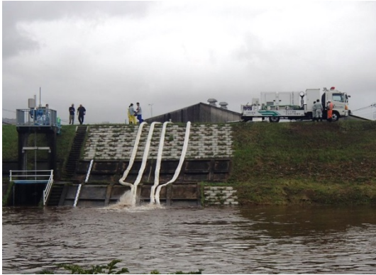
近年の排水ポンプ車稼働実績 (H27: 台風18号(三島市御園地区))
