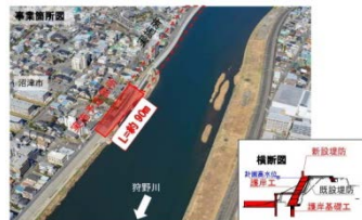
①堤防高不足区間において築堤護岸整備
