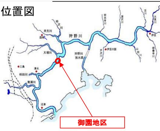
・三島市御園地区は**樹木の繁茂により、川の流れを阻害することから、整備計画目標流量 $2,200\text{m}^3/\text{s}$ (1/50程度)を安全に流すために、**樹木伐開**を行います。**
