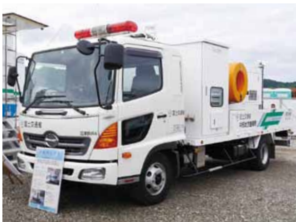
沼津河川国道事務所 排水ポンプ車
