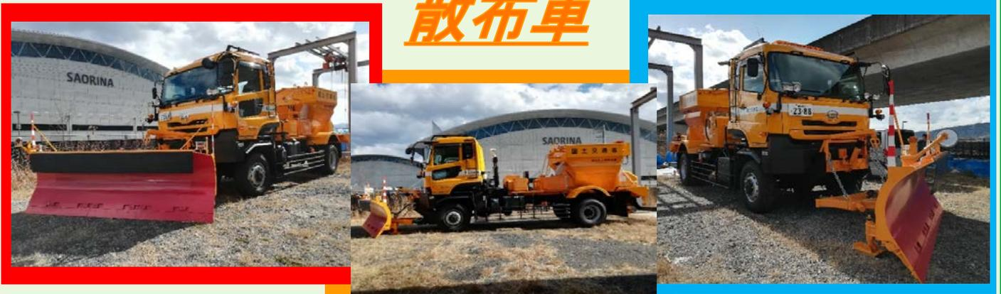
散布車が入りました。冬の道路は、雪が積もってなくても気温が2度くらいになると道路が凍ってしまい、車がスリップしてしまいます。凍結防止剤散布車(とうけつぼうしざいさんぷしゃ)は、道路を凍りにくくするために、後ろに付いている散布円盤(さんぷえんばん)から、凍結防止剤などを道路にまんべんなくまくための装置を搭載(とうさい)した車です。後ろのタンクには4トンくらいの塩化ナトリウムを積んで、まき出しながら走ります。円盤は、高速で回転して3メートルくらいの幅でまきだします。降り積もった雪は、前についているプラウで道路わきによせます。散布車を見かけたら、散布車との車間距離を十分とって気をつけて走行してください。
