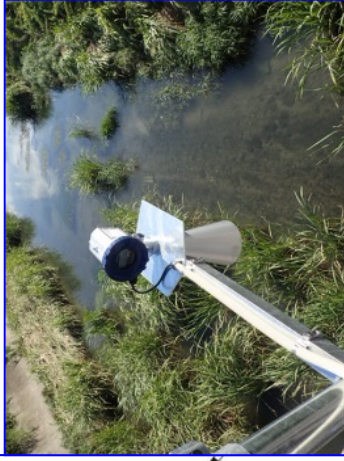
【三重県】危機管理型水位計の設置 (勢田川1箇所、汁谷川1箇所、8月完了)
