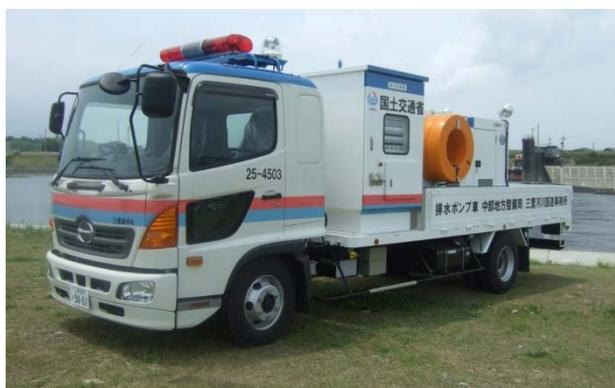
排水ポンプ車は、発電機と排水ポンプ、ホースなどを搭載し、浸水被害現場へ出動し、1台で排水作業をすばやく行なえる車両です。
