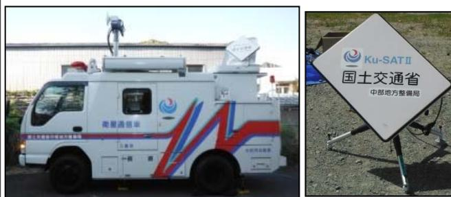
○衛星通信車は、衛星を通じて、日本国内の被災箇所の画像、音声などの情報通信手段を提供する車両です。
