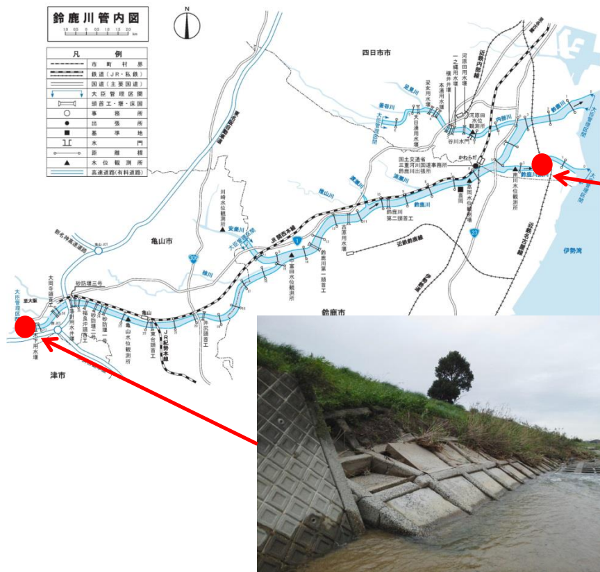
上: 堤防の裏面崩落 鈴鹿川派川右岸1.8k
