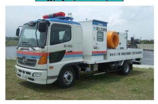
排水ポンプ車は、発電機と排水ポンプ、ホースなどを搭載し、浸水被害現場へ出動し、1台で排水作業をすばやく行なえる車両です。
