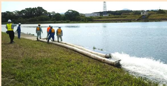
排水ポンプ車の訓練では荷台からポンプや、ホースを下ろして敷設。車体横で発電機を操作し櫛田川の水をくみ上げ模擬排水しました。
