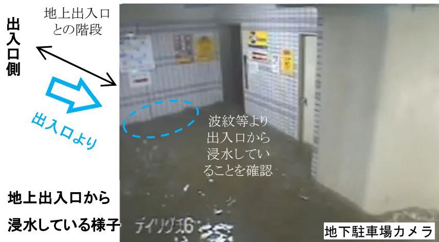
地下1階への浸水開始状況
