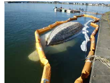
転覆した船舶に オイルフェンスを展開
