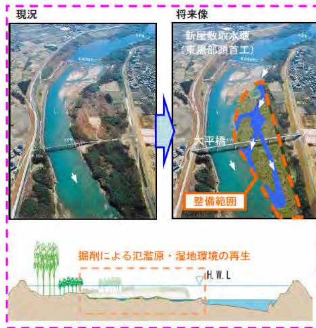
河道内の氾濫原・湿地環境の再生イメージ (大平橋付近)
