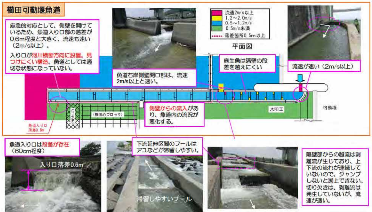
図-3.3 (4) 堰・頭首工の魚道及び河道状況の課題（櫛田可動堰）
