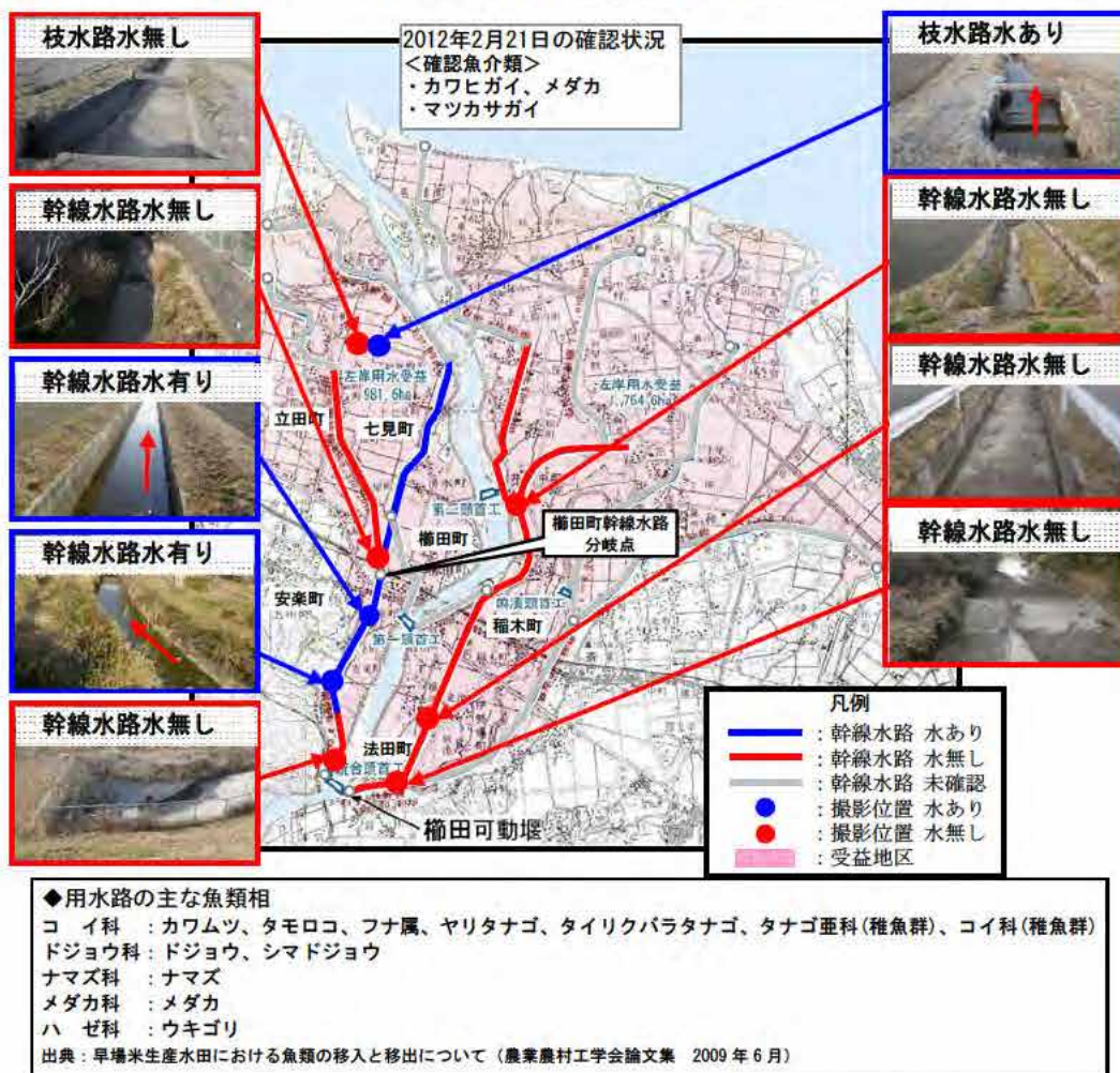
図-2.31 榊田可動堰下流の用水路網と水溜まり、水枯れ状況
