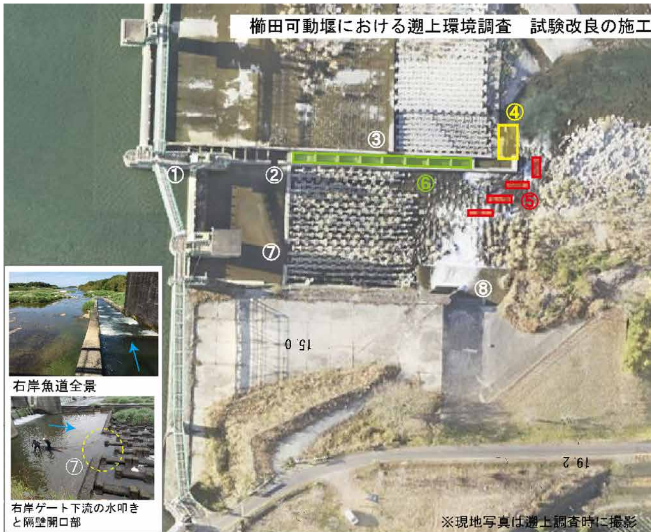
⑥ 〇延伸区間 (H3 施工) は魚道プール水深が大きく、アユ等が滞留しやすいと考えられる。既往文献・知見を参考として、大型土のうを設置してプール水深を 40cm 程度にした。
