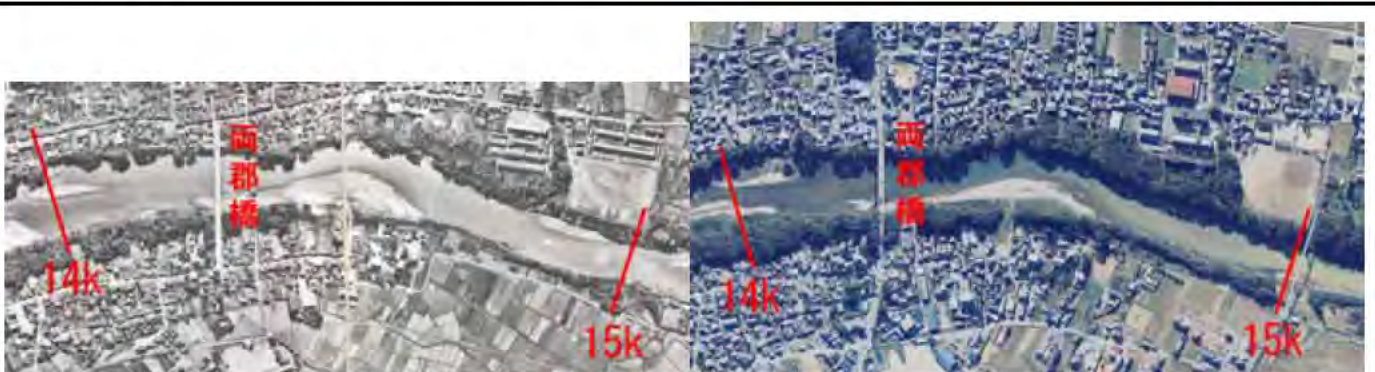
図 2-1-7 樹木群拡大 (左：昭和 36 年、右：平成 10 年) 樹木群が川側に拡大している。
