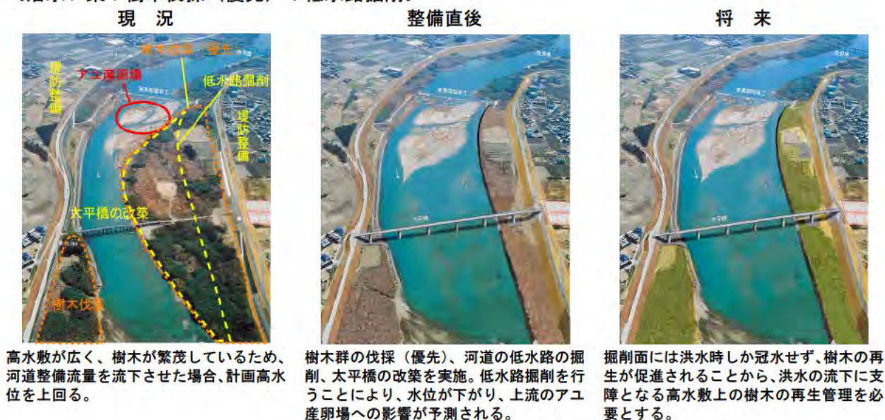
写真5 大平橋付近の改修イメージ
