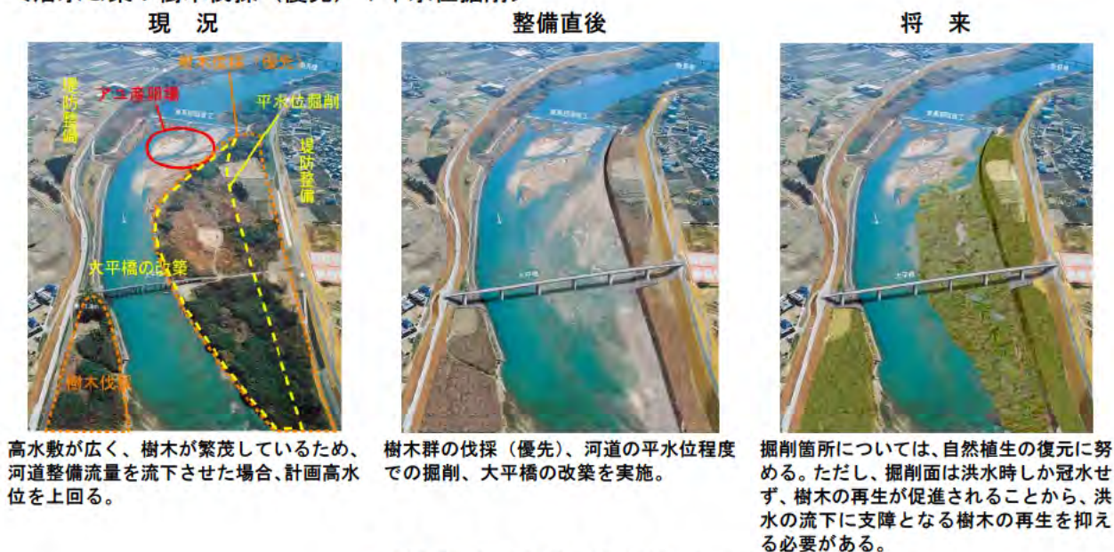
写真6 大平橋付近の改修イメージ
