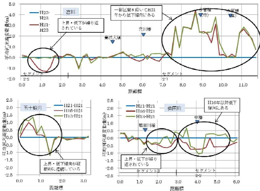
図 2-2 平均河床高変動変化図
