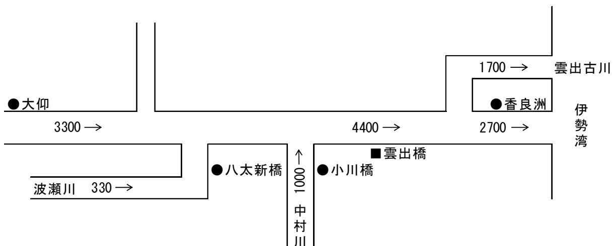
図 2-1 雲出川計画流量図 河川整備計画(単位:m<sup>3</sup>/s)
