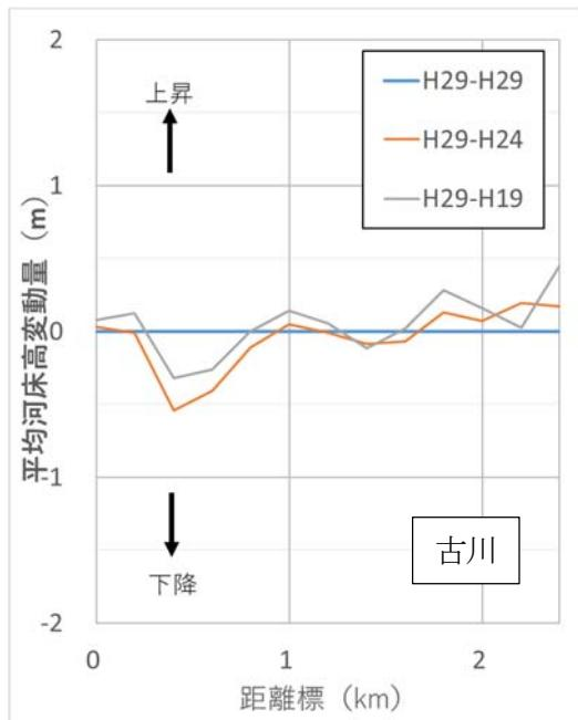
図 2-2 平均河床高変動量経年変化図(本川・古川)
