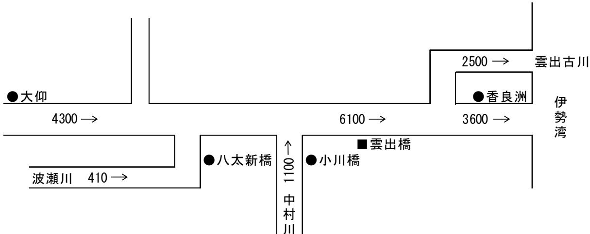
図 1-8 雲出川計画流量図 河川整備方針(単位: $\text{m}^3/\text{s}$ )
