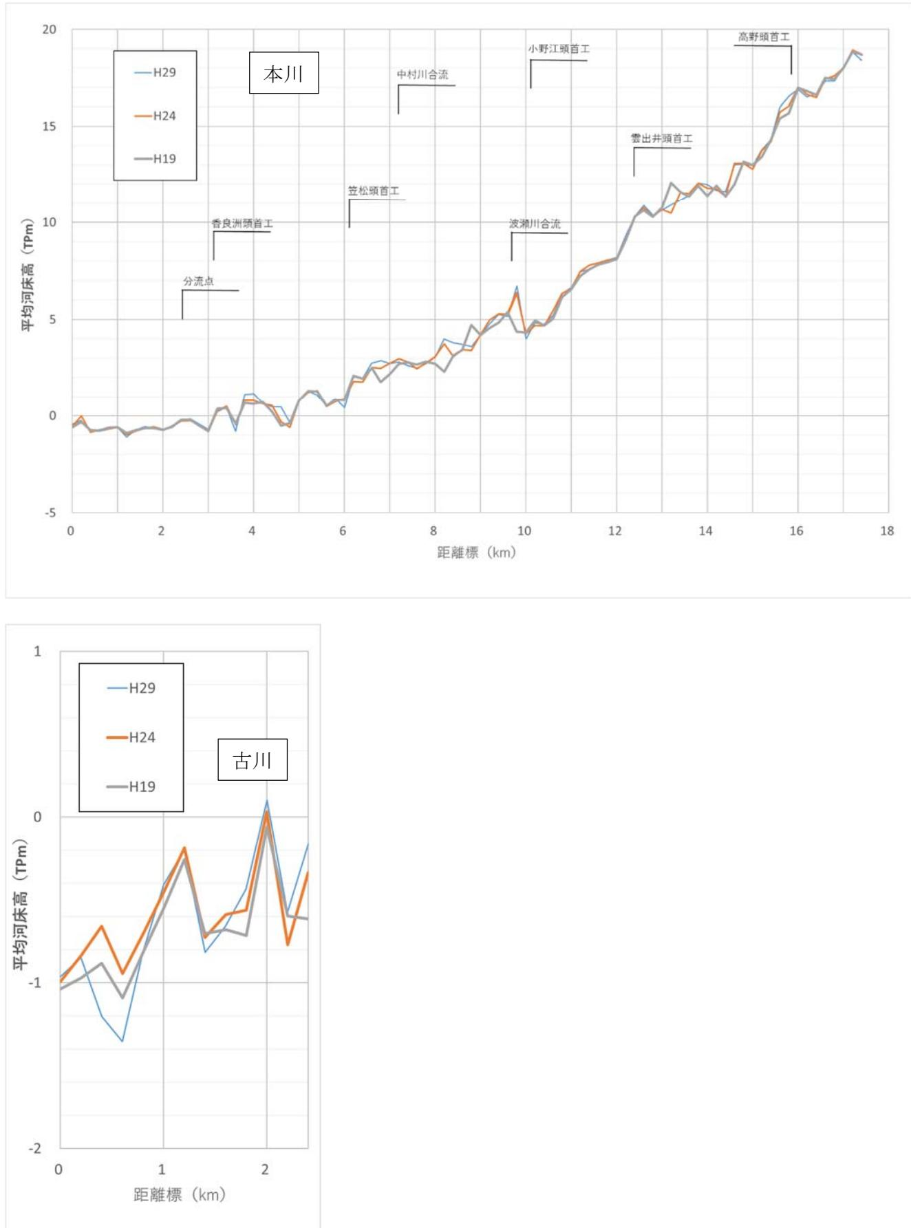
図 1-12 平均河床高経年変化図(本川・古川)
