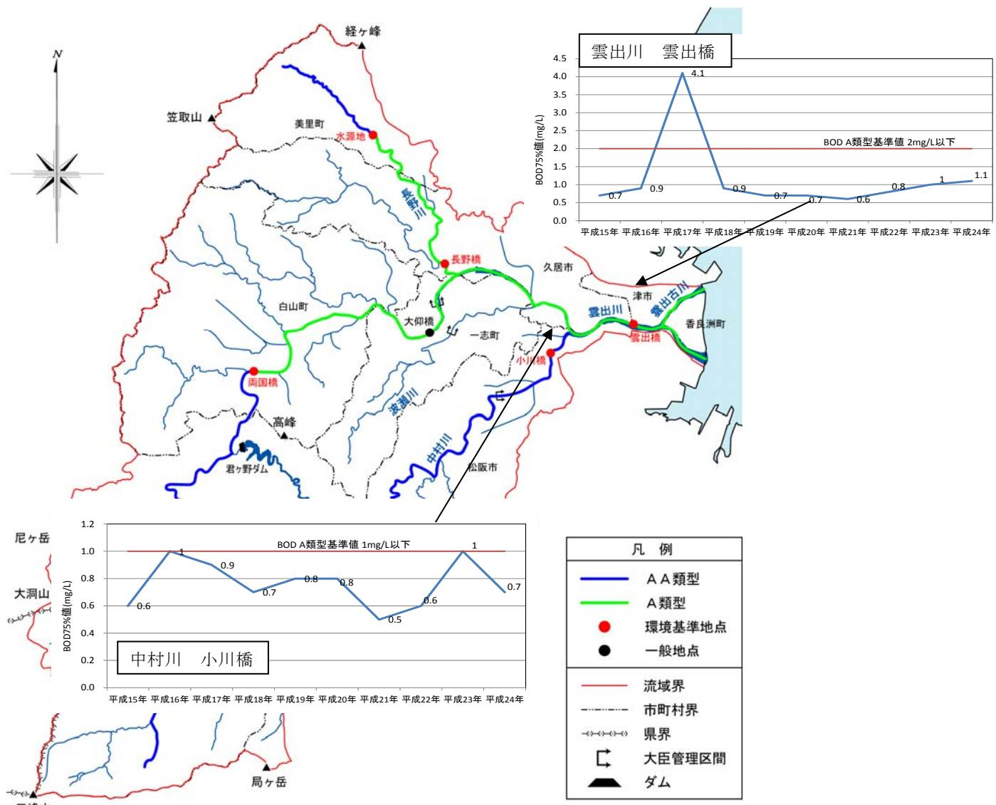
図 1-19 水質類型指定図(雲出川)
