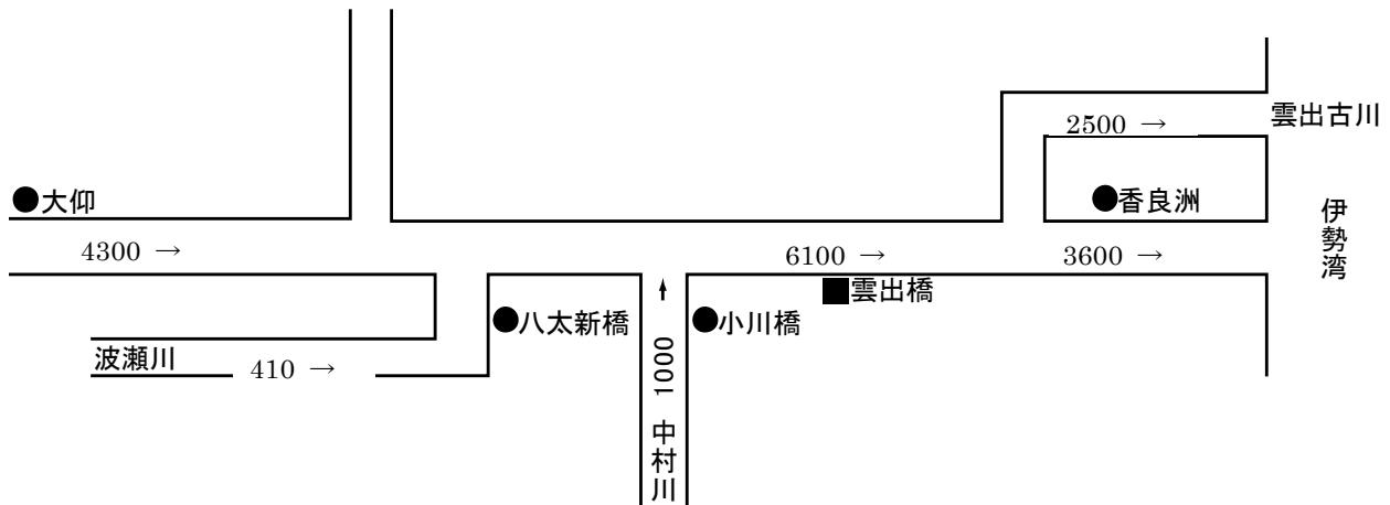
図 1-9 雲出川計画高水流量図 河川整備方針(単位:  $\text{m}^3/\text{s}$ )
