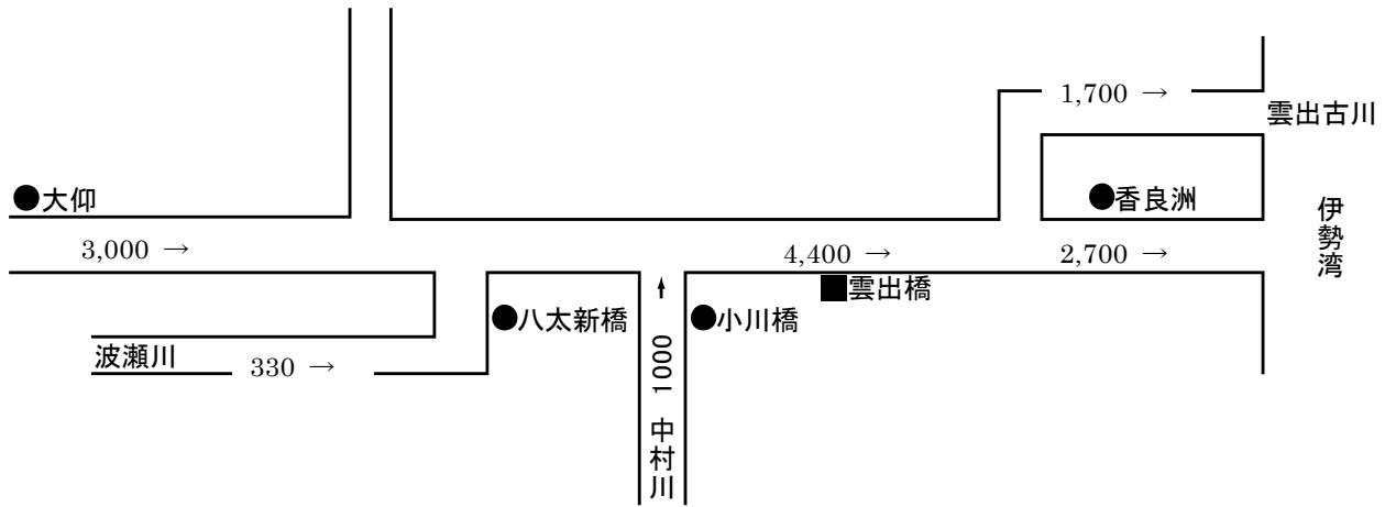
図 1-10 雲出川整備計画流量図(単位: $\text{m}^3/\text{s}$ )
