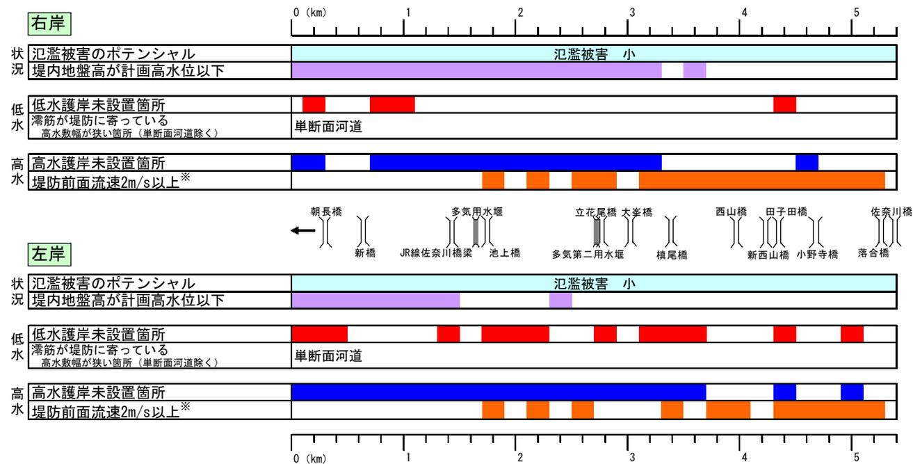
※堤防前面流速2m/s：堤防法面の張芝等が侵食に耐えうる流速の目安
