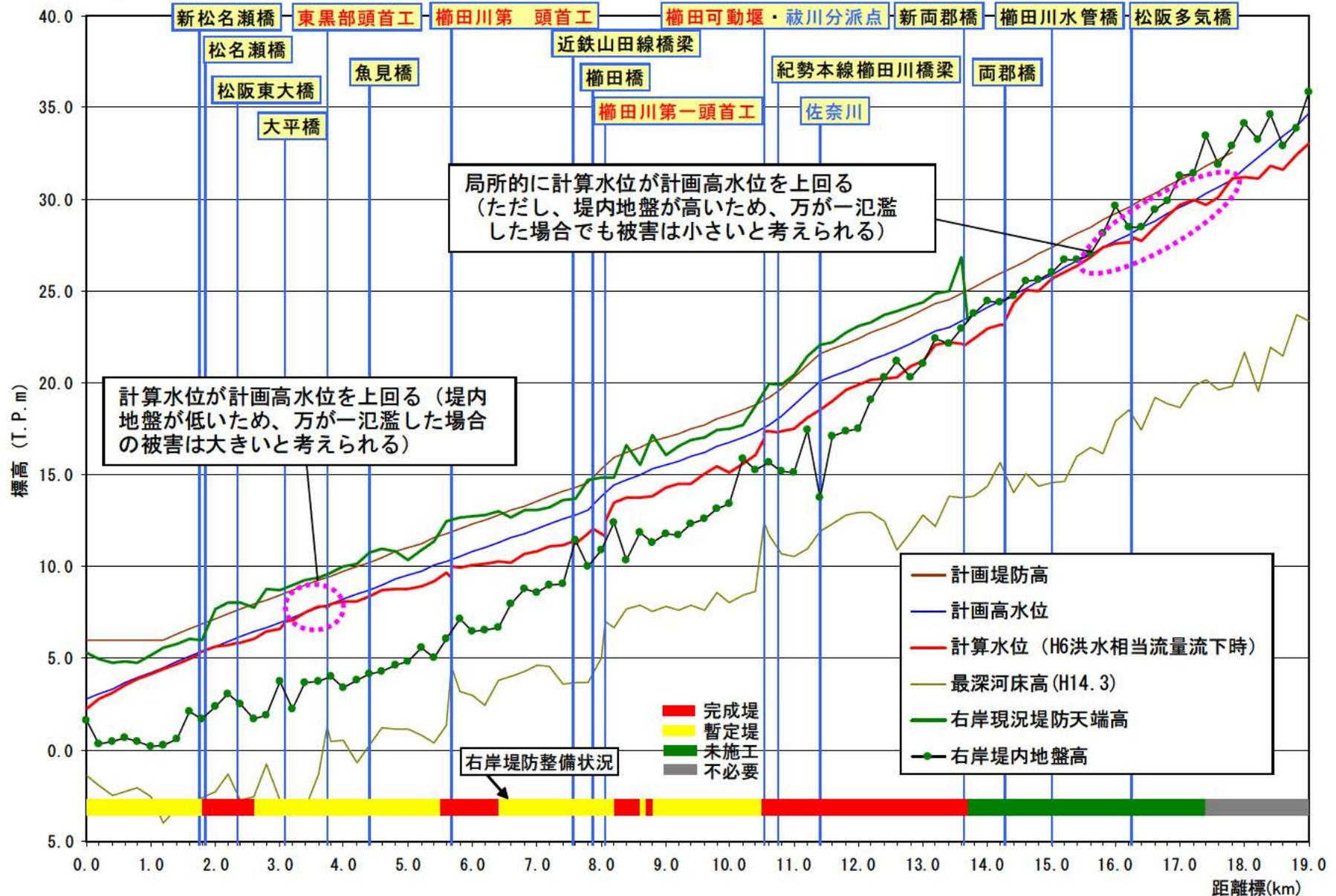
佐奈川（平成6年9月洪水実績の水位縦断図）＜右岸＞
