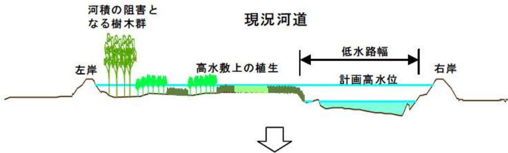
洪水位を計画高水位以下まで低下させるために必要な河積。この分の河積が不足する。
