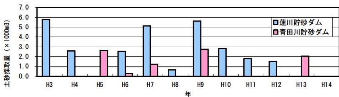
貯砂ダムにおける土砂採取量実績
