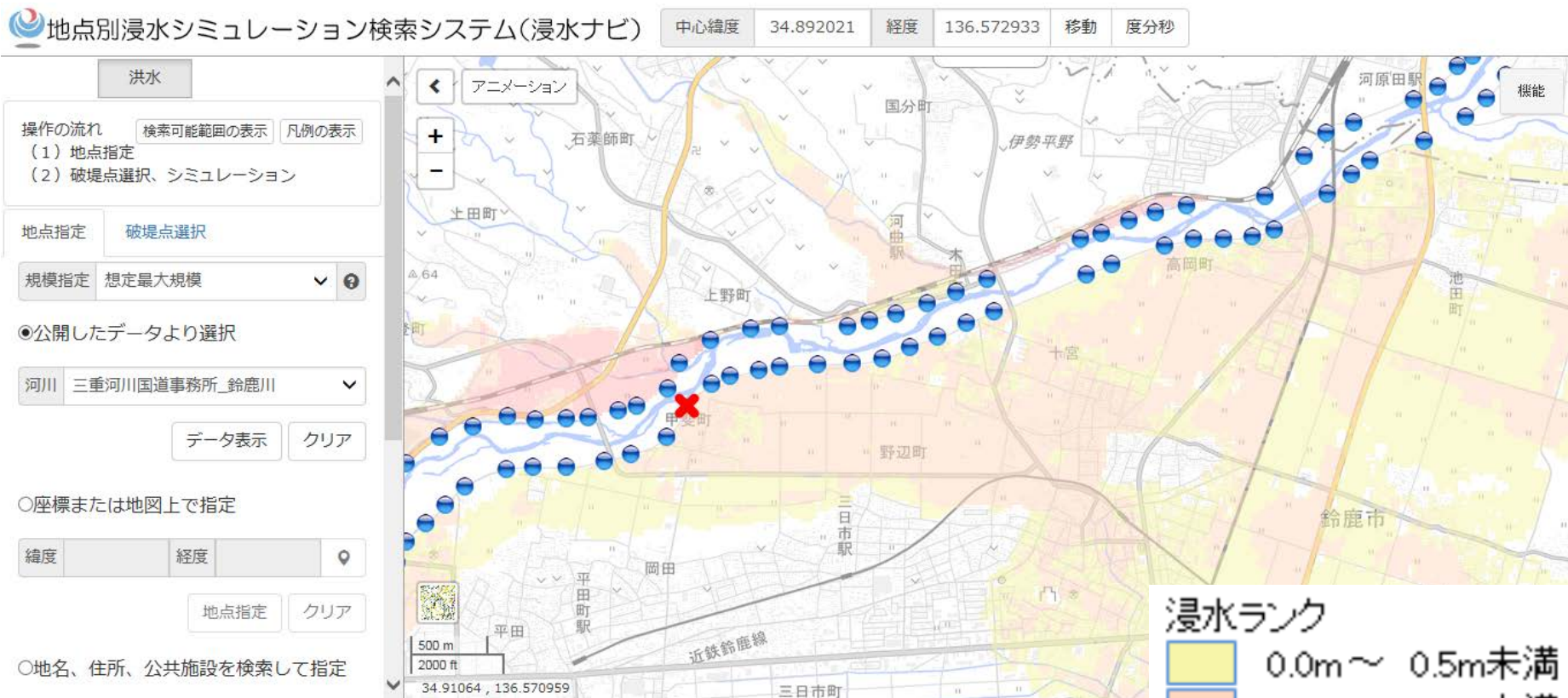
鈴鹿川右岸10.6k地点が破堤した場合の浸水図
