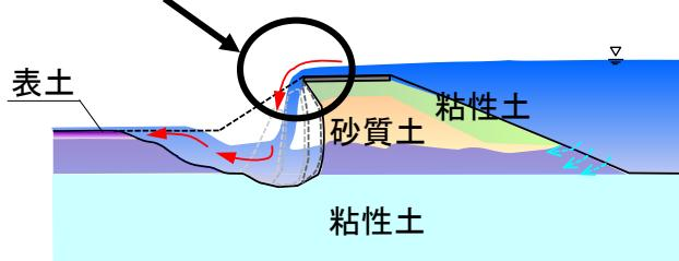
堤防天端をアスファルト等で保護した堤防では、ある程度の時間、アスファルト等が残っている。
