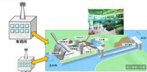
遠隔監視・操作化により、緊急時においても排水作業が可能 (排水機場の遠隔化イメージ)
