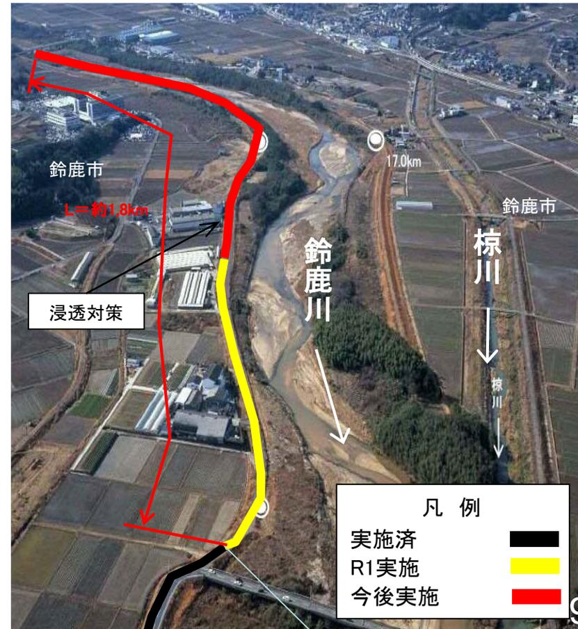
➤ 整備目標流量を安全に流下させるため、堤防整備、護岸整備、河道掘削、樹木伐採を重点的に進めています。河川整備計画に基づく事業の進捗率は、事業費ベースで約10%程度となっています。
