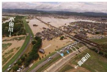
高梁川水系小田川左岸及び複数の支川の決壊、右岸の越水により、多数の家屋が浸水
