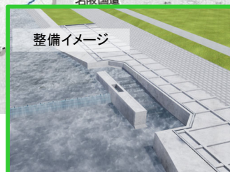
横断工作物改築と併せた縦断連続性の確保（三重河川国道事務所）
