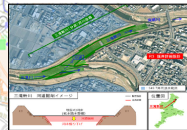
【三重県】 海蔵川 河道掘削, 護岸整備 堰改築, 橋梁改築, 耐震対策 等
