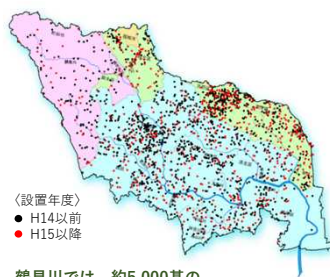
鶴見川では、約5,000基の雨水貯留浸透施設が整備済み 鶴見川流域内の防災調整池等位置図
