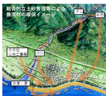
長島ダムの掘削土を駿河海岸の養浜に活用(静岡県)
