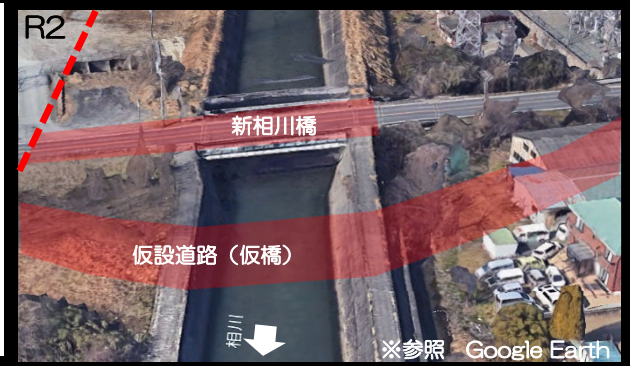
早期のネック点解消に向けて 仮設道路と仮橋の設置工事に着手！
