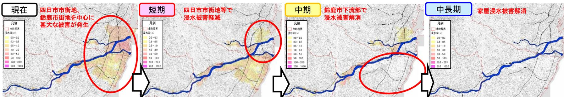
※上記の効果は、現時点では洪水氾濫対策（国）を各工程段階で実施した条件で、国管理区間において河川整備計画と同規模の洪水が発生した場合に、各氾濫ブロックで被害最大となる1箇所の堤防を決壊させた場合の想定氾濫区域を示しています。
