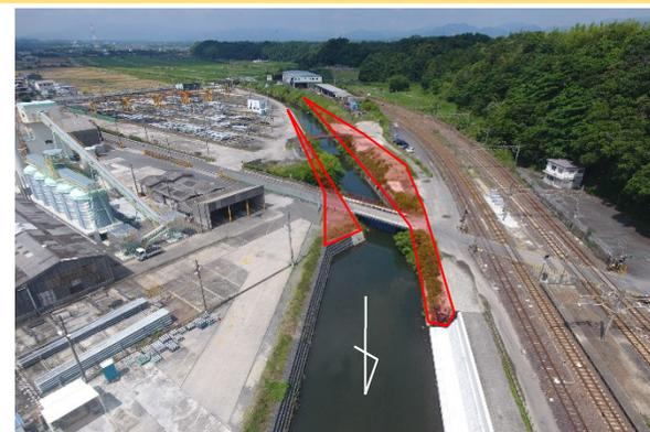
河川断面が狭かった1号橋を架け替えることで治水安全度の向上を図る。
