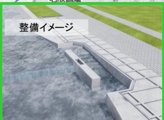
横断工作物改築と併せた縦断連続性の確保 (三重河川国道事務所)
