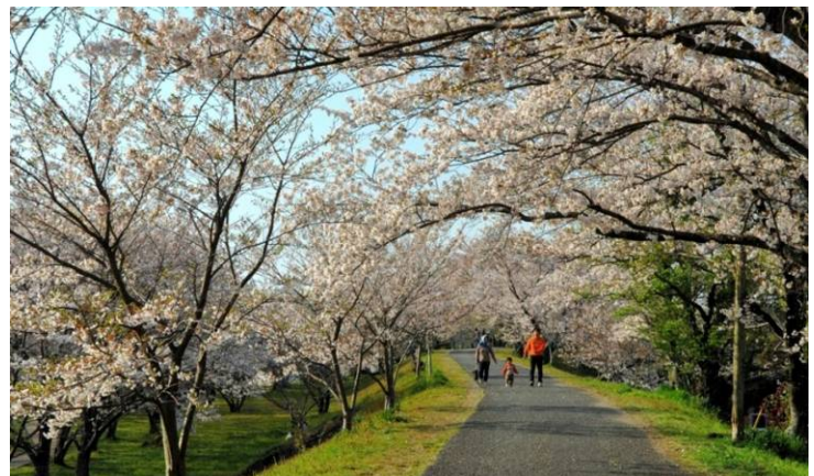
現在の桜堤：舗装幅は3mで、両サイドに1～1.5mの草地があるので自然的で柔らかい印象。現在の空間イメージを手本にする。
