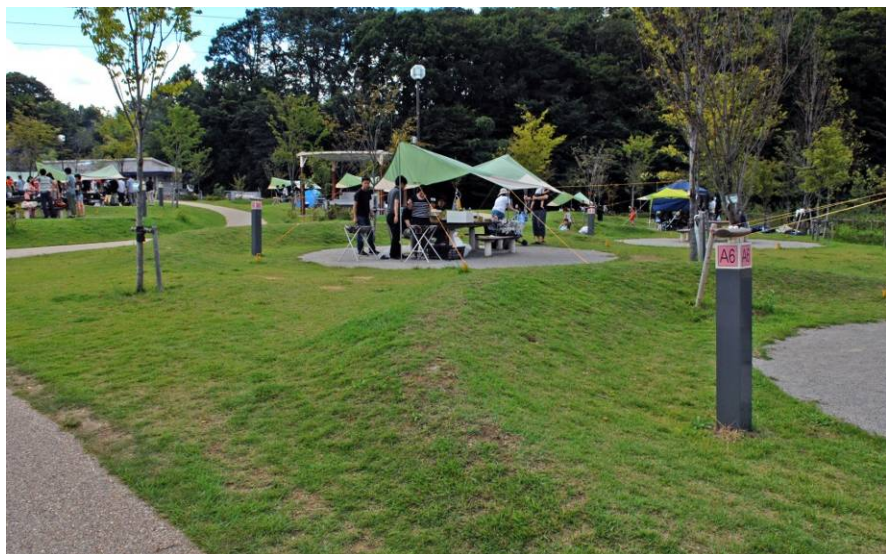
月の輪のイメージ（横浜市 玄海田公園）：側帯の桜の脇や小広場に月ノ輪（水防工法のひとつ）の形をした小盛土を配置する。日常的には座るなどの使い方。洪水時には水防資材（土嚢の土）として活用できる。
