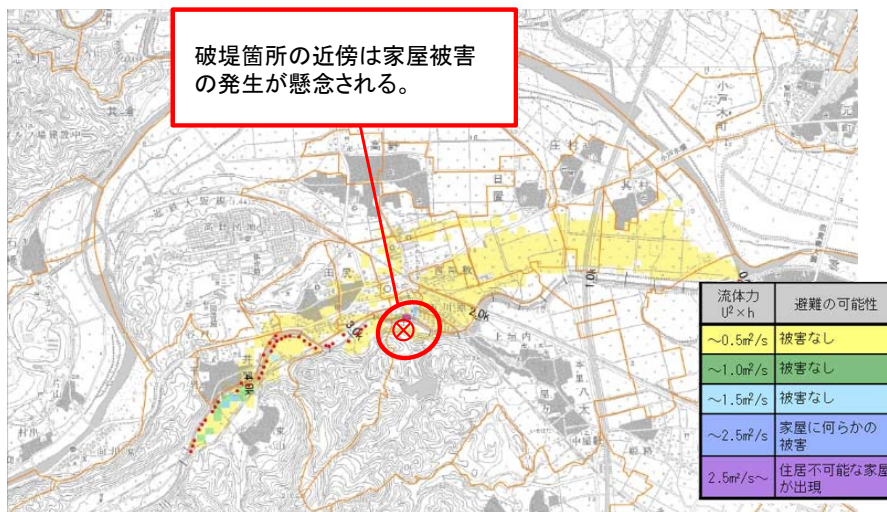
持続型洪水：越水+破堤（流体力）
