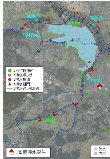
図 18 浸水実績図 (中村川・赤川流域)
