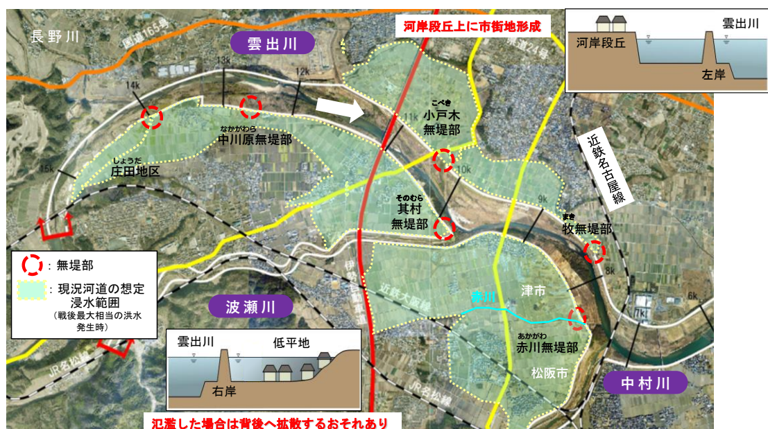
図 13 雲出川 中流部無堤部の概要
