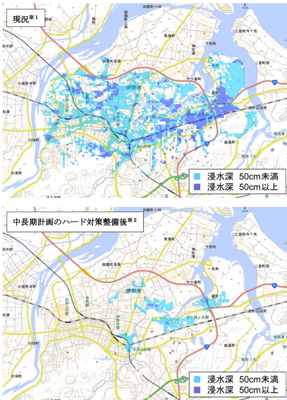
図 2-16 平成 29 年 10 月（台風第 21 号）の高潮・洪水におけるハード対策整備効果（現況及び中長期計画整備後）
